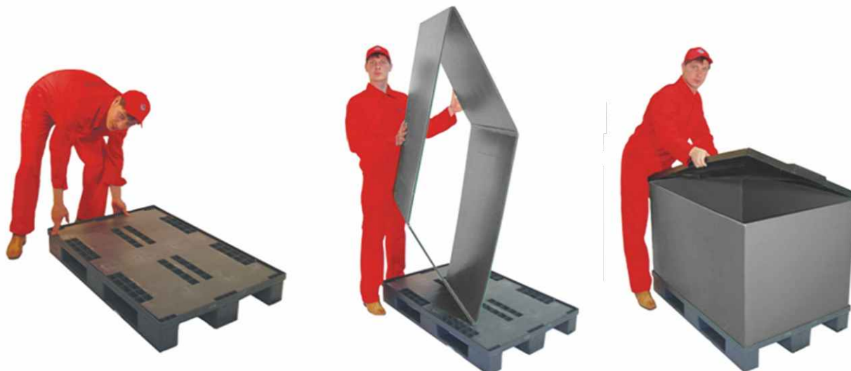
Процесс сборки контейнера
